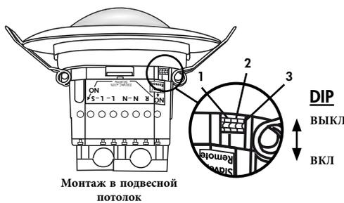
DIP 1 Автоматический/полуавтоматический режим
