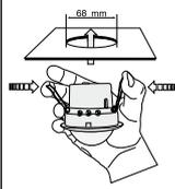
Этот датчик был специально разработан для монтажа в подвесные потолки.
