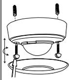
Датчик устанавливается на твердой и ровной поверхности. Перед установкой необходимо снять круглую крышку-кольцо (поверните против часовой стрелки).
