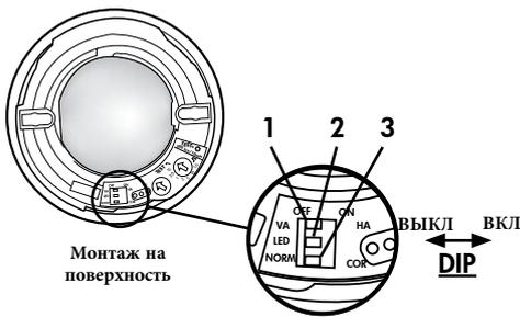
DIP 1 Автоматический/полуавтоматический режим
