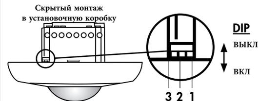
DIP 1 Автоматический/полуавтоматический режим LED
